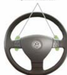
Conmutadores del Tiptronic en el volante EB9
